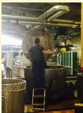
Figura 4.5: empleo de escaleras para minimizar las posturas forzadas (fuente: imagen tomada durante el estudio de campo)
